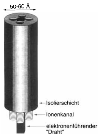
Abb. 3. Schematische Darstellung des mehradrigen molekularen Kabels, das durch Selbstorganisation des Kronenether-Phthalocyanins 1 gebildet wird. In der Mesophase rotieren die individuellen Moleküle vermutlich um ihre Stapelachse [10].
